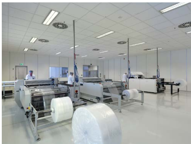
Bild 3. Reinraumproduktion zur Herstellung von Reinraumverpackungen (© Strubl)
